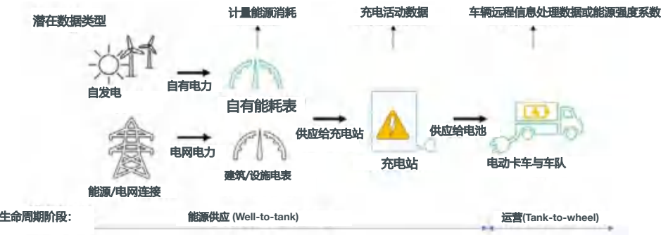
图 2 从电网电表到车辆的电力传输路径和各种数据的说明
