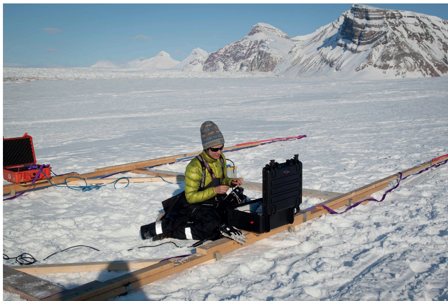
Pendant sa thèse, Dorothée a passé quelques semaines sur le terrain pour collecter des données au Svalbard. Sur cette photo, elle met en route le radar qui sera suspendu sous un hélicoptère pour mesurer l'épaisseur du glacier Kronebreen près de Ny Ålesund.
