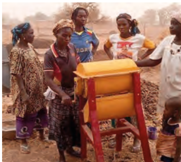
Outil d'enrobage de graines conçu par l'ONG AVSF.
